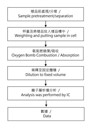
鹵素分析流程圖 / Analytical flow chart of Halogen
